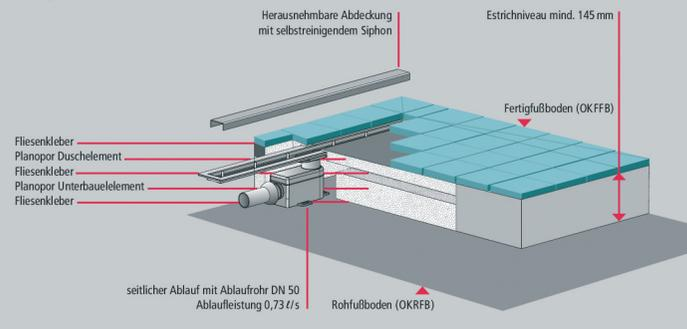
Sollten Sie die Möglichkeit haben eine „Kernbohrung“ zu machen und den Geruchverschluss unter die Decke zu legen (bei darunter liegenden Räumen), benötigen Sie nur einen Estrich Aufbau von 40 mm. Somit ideal dort wo die Estrichhöhe eigentlich nicht ausreicht.
