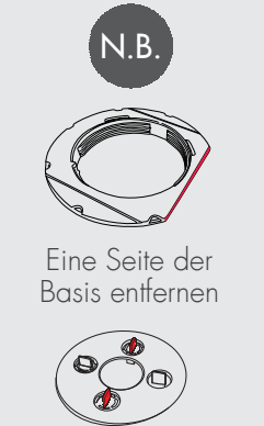
E-1. Den Clip SUPACLPB unter dem Basisteil des Stelzlagers positionieren.
