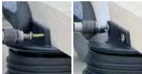
20. Den Balken am Träger mit den vorgesehenen Schlitz anschrauben.
